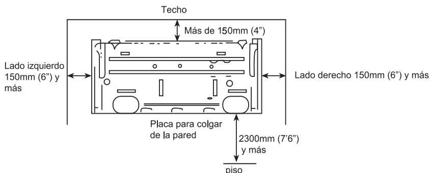
**Atención:** Si hay algunos dispositivos de función adicionales que se deben instalar en el aire acondicionado, asegúrese de añadir espacio en la instalación para estos dispositivos de función.
