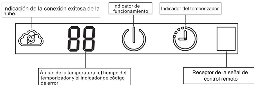
La figura de arriba muestra todas las indicaciones para el propósito de la explicación pero prácticamente solo se indican las partes pertinentes. El indicador puede ser cambiado, pero no afecta a su funcionamiento.
